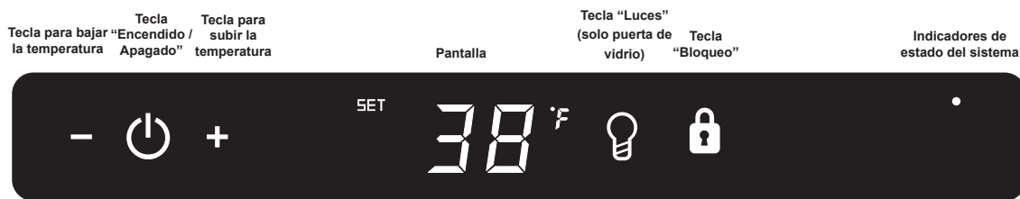
Figura 12 Control electrónico para una sola zona
